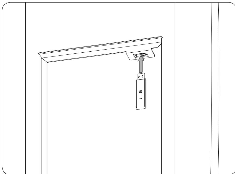
Pour effectuer le chargement des données, la borne doit être sous tension.
