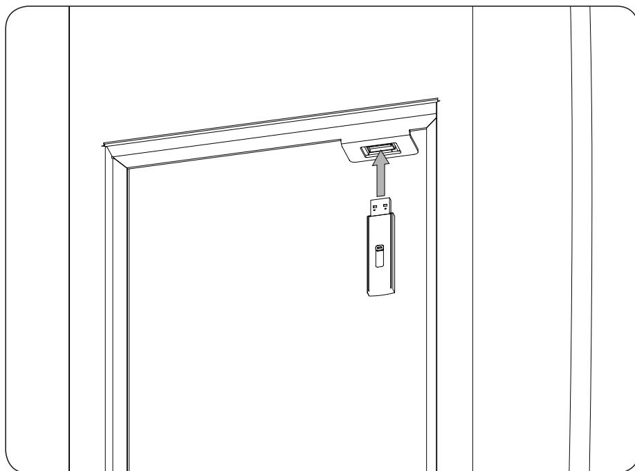
Para efectuar la carga de datos la estación debe estar energizada.
